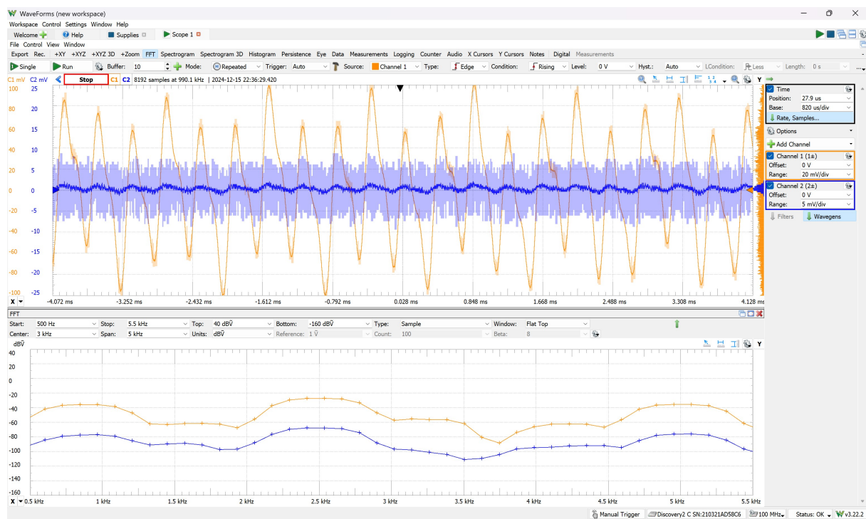
FIGURE 3.6 – Réponse du haut-parleur pour 3 signaux aux fréquences 1 kHz, 2.5 kHz et 5 kHz
