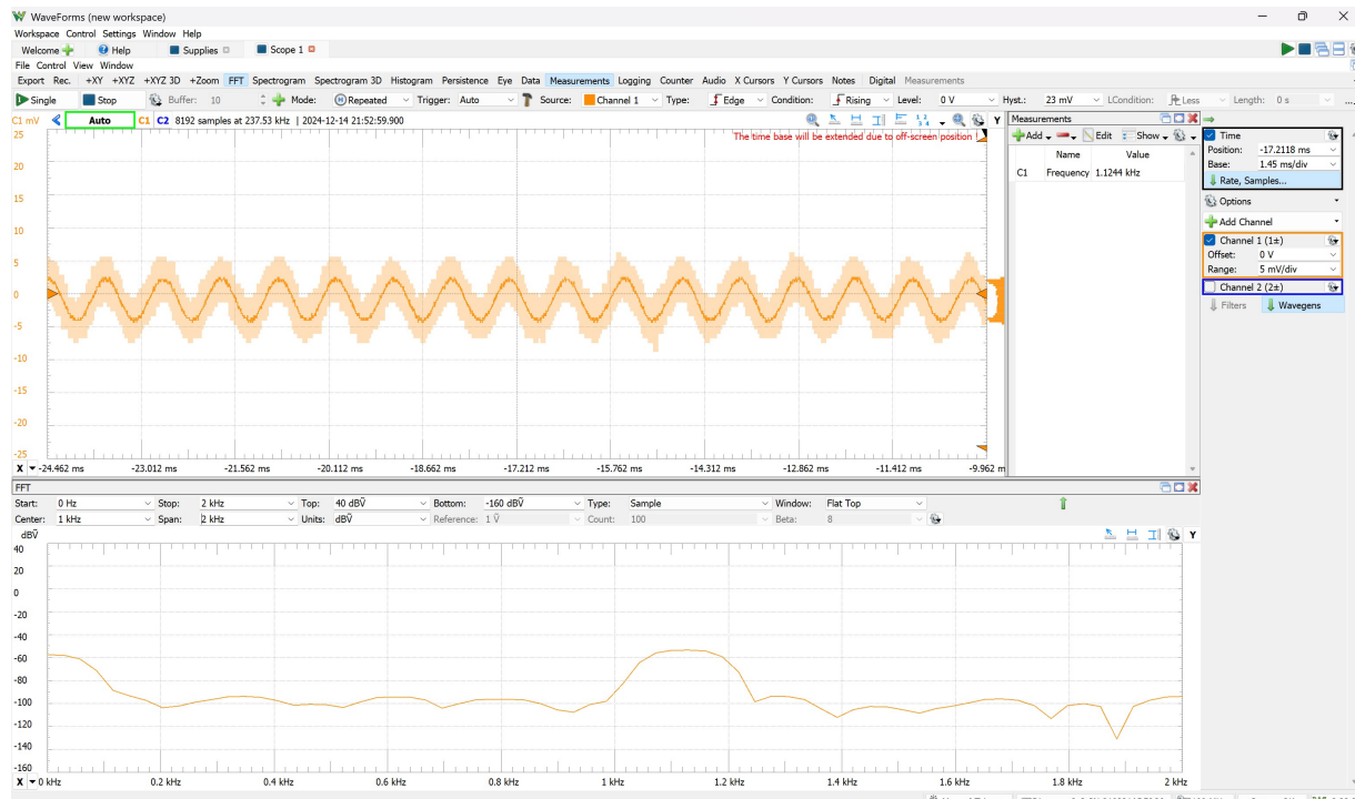
FIGURE 3.3 – Réponse du haut-parleur pour une fréquence de 1.2KHZ
