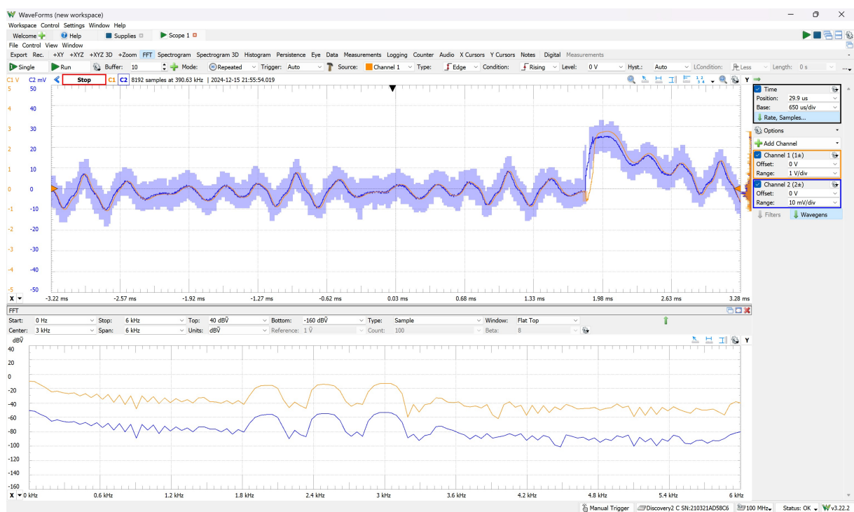
FIGURE 3.8 – Réponse du microphone pour 3 signaux aux fréquences 2 kHz, 2.5 kHz et 3 kHz
